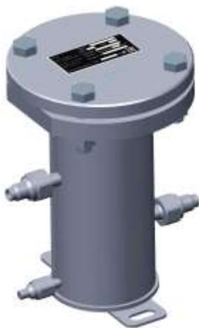
Фильтры сетчатые жидкостные типа ФС, ФСЖ предназначены для очистки от механических примесей агрессивных, токсичных и вредных жидкостей, эмульсий и суспензий. Фильтры устанавливаются на всасывающих линиях дозирочных насосных агрегатов и установок.
